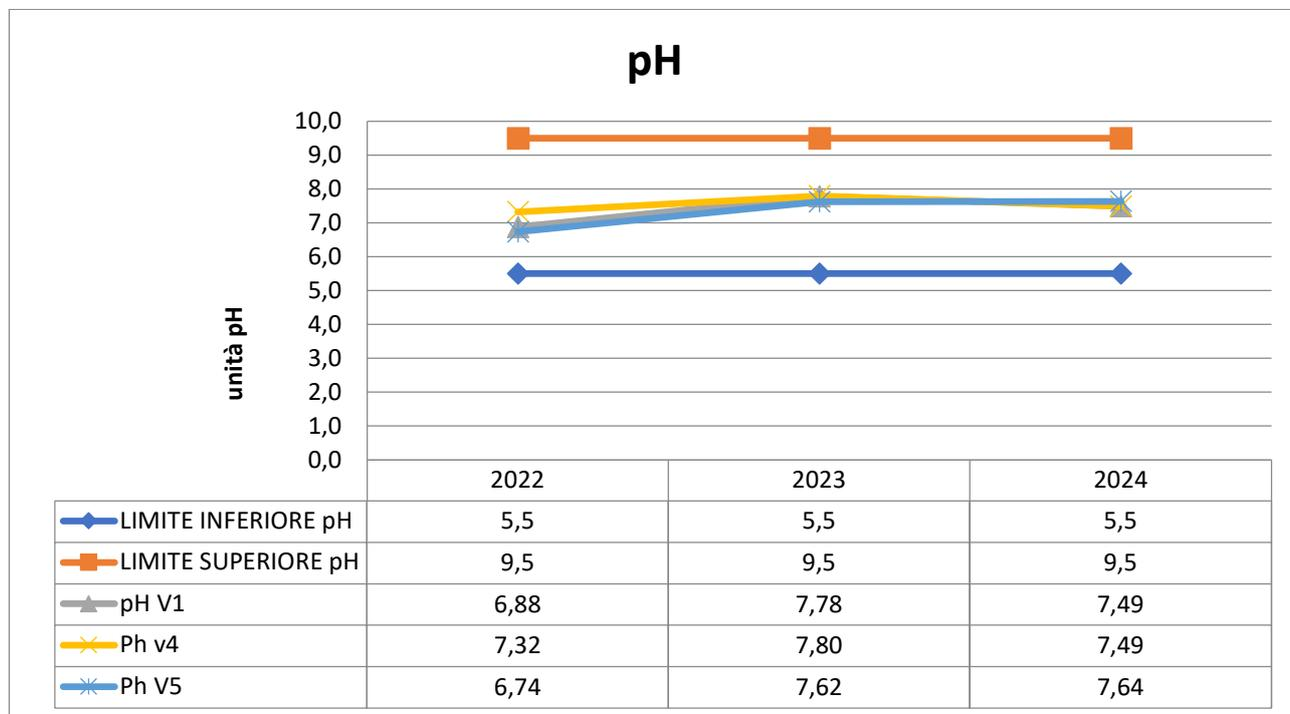
Figura 13 – Monitoraggio parametro pH sulle acque di prima pioggia
