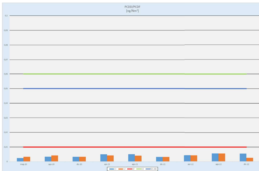
Grafico. n. 17 PCDD/PCDF: valori rilevati nei campionamenti discontinui sulle emissioni E25 ed E26 anni [2020-2022].
